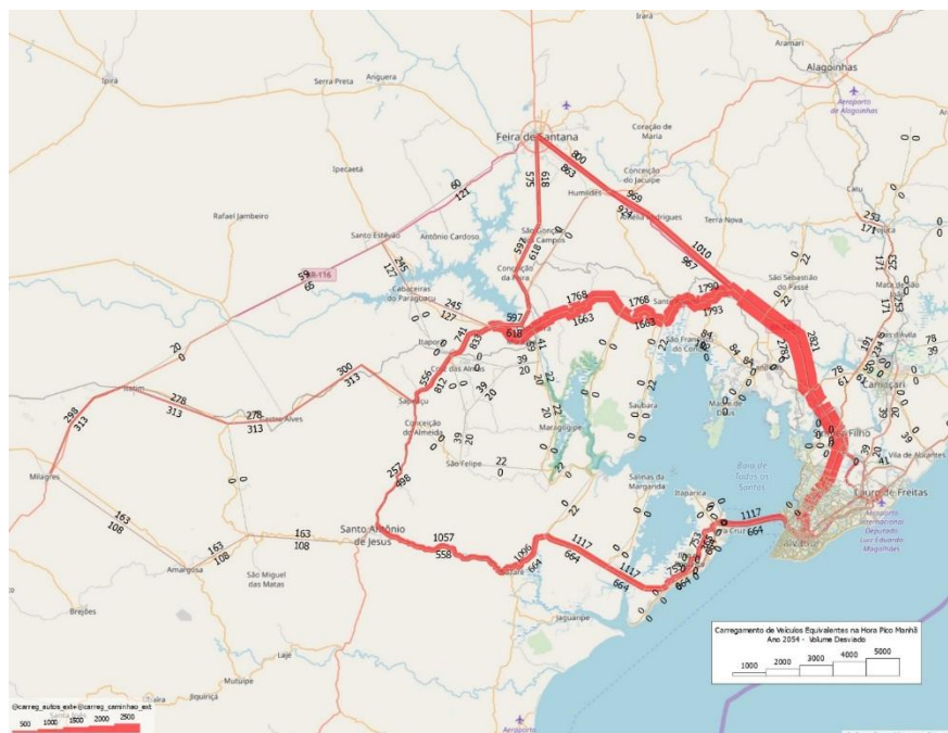
Figura 55 – Carregamento de veículos equivalentes na Hora Pico Manhã gerado pela matriz de longa distância - Ano 2054
