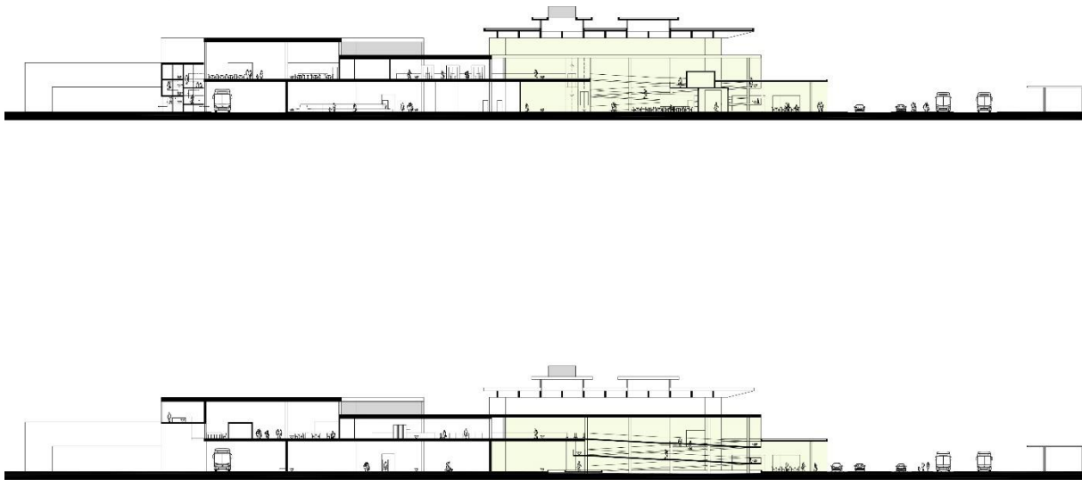
Figura 3-54: Zona Amarela assinala a Praça no Lado Terra com ventilação natural
