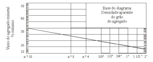
Diâmetro máximo do agregado
